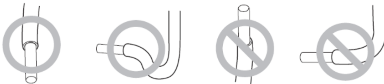
Obr.8 – ZÁKLADNÍ CHYBY UPEVNĚNÍ SENZORŮ TEPLoty NA POTRUBÍ
