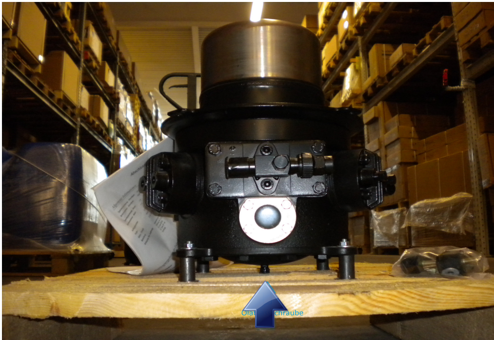
Šroub pro vypuštění oleje na spodku kompresoru
